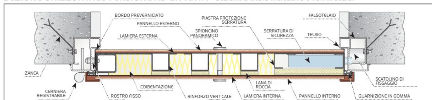
SEZIONE ORIZZONTALE VERSIONE AD UN'ANTA - Sezione a titolo indicativo e non in scala.
